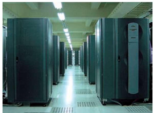
図 1 名古屋大学情報連携基盤センターのスーパーコンピュータ PRIMEPOWER HPC2500。並べられている冷蔵庫よりも大きな“箱”の中にパソコン 60 台分の能力を持つコンピュータが入っている。
