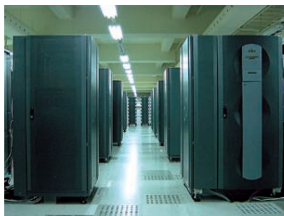
図 1 名古屋大学情報連携基盤センターのスーパーコンピュータ PRIMEPOWER HPC2500。並べられている冷蔵庫よりも大きな「箱」の中にパソコン 60 台分の能力を持つコンピュータが入っている。
