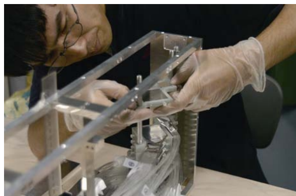
LHCf 用小型電磁シャワー検出器と完成を喜ぶ人々（左図）。実際の検出部分は最下部にある 2 cm 角、長さ 24 cm の「太巻き」2 本分。実際には「サンドイッチ」で、7 mm 厚タングステン板とプラスチックシンチレータ（放射線が通ると光る）を 22 層重ねている。右図は組み立て中のひとコマ。
