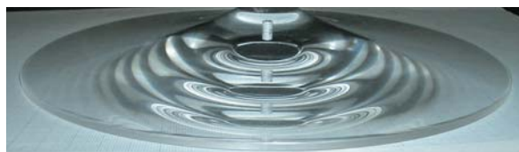
写真1 プラスチックで作った重力レンズと等価なレンズ。富士山のような形をしている。
