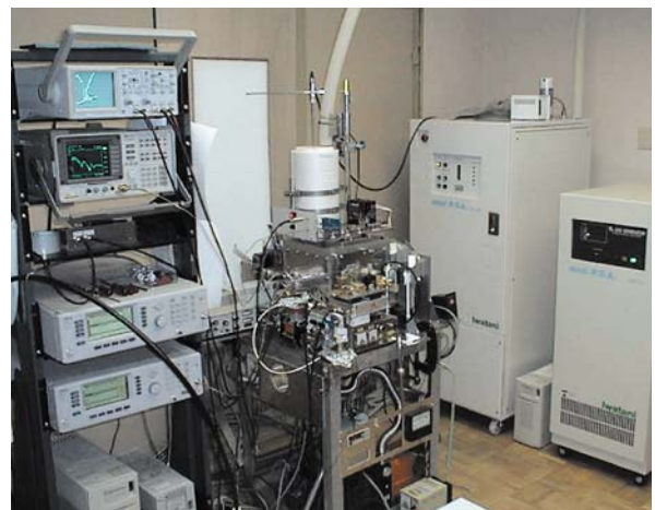
南米チリ共和国で稼働中の200 GHz帯大気微量分子観測装置。
