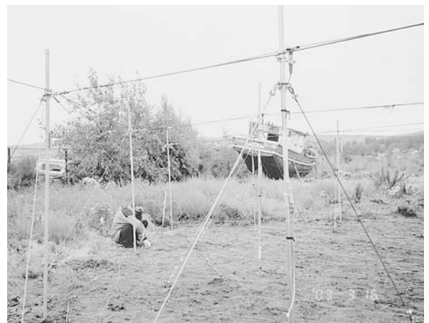
マゼラン大学農場に設置したイメージングリオメータのアンテナ。後ろにPUNTA ARENASの船名が入った廃船が見られる。
