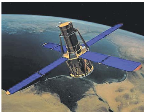
図1 RHESSIの軌道上での想像図。筒状の部分の上部から入ったX線/ガンマ線が2層のすだれコリメータを通り、下部の検出器に入ります。RHESSIは、この硬X線/ガンマ線望遠鏡以外の観測装置は搭載しておらず、太陽高エネルギー現象の観測に特化した衛星です。
