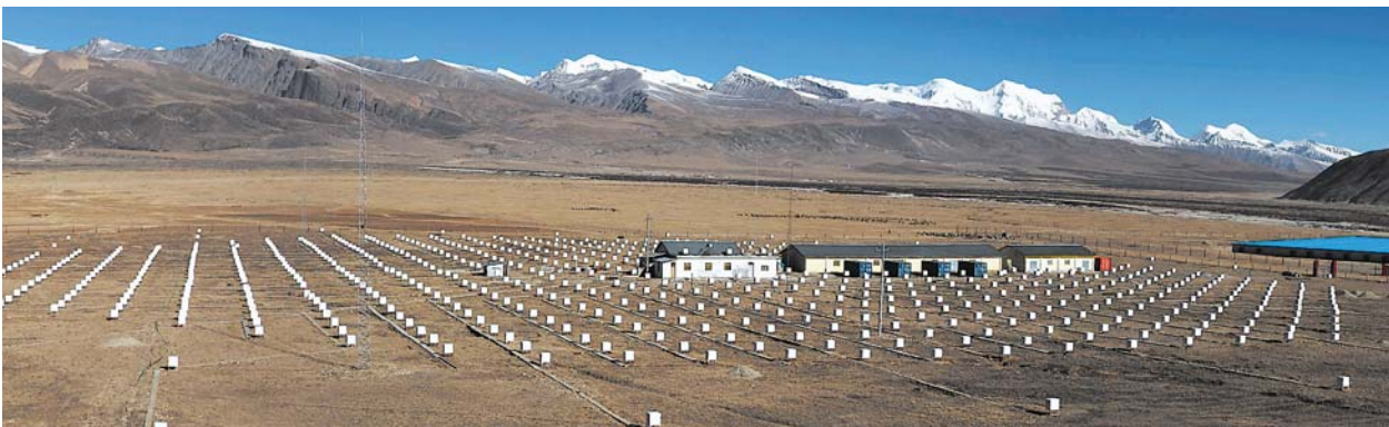
チベット高原（標高4300 m）に設置された世界最大の高精度空気シャワーアレイ。アレイ中央の右手の建物に太陽中性子望遠鏡と中性子モニターが設置されている。
