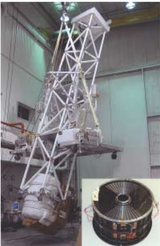
気球に搭載された多層膜スーパーミラー硬X線望遠鏡システムと先端部に取り付けられた望遠鏡本体(口径40 cm、焦点距離8 m)。アメリカにて2001年7月5日に飛揚。
