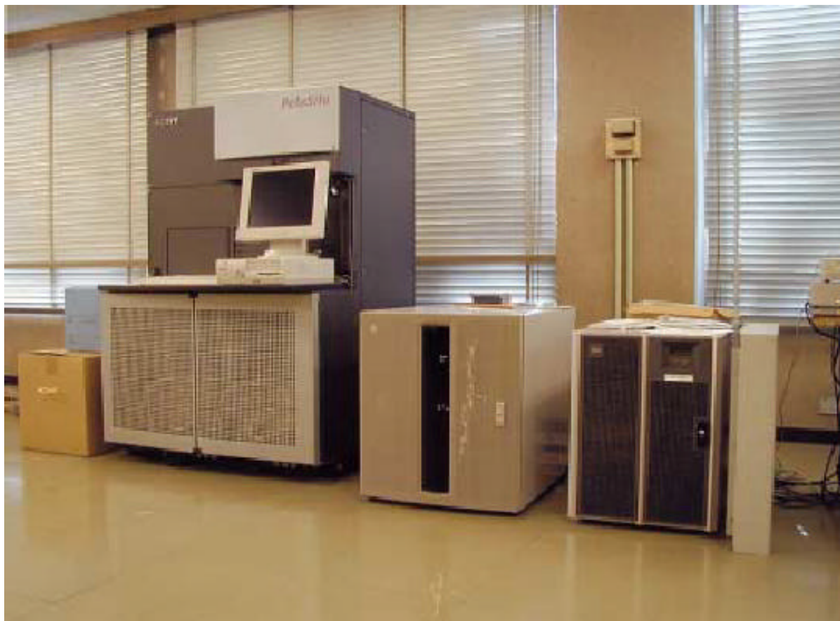
計算機更新で導入された大容量記憶装置 (左)、ディスクアレイ (中)、および計算サーバ (右)
