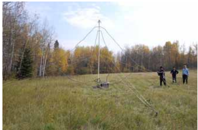
図1. カナダ・アサバスカ観測点に設置されたVLFアンテナ。
