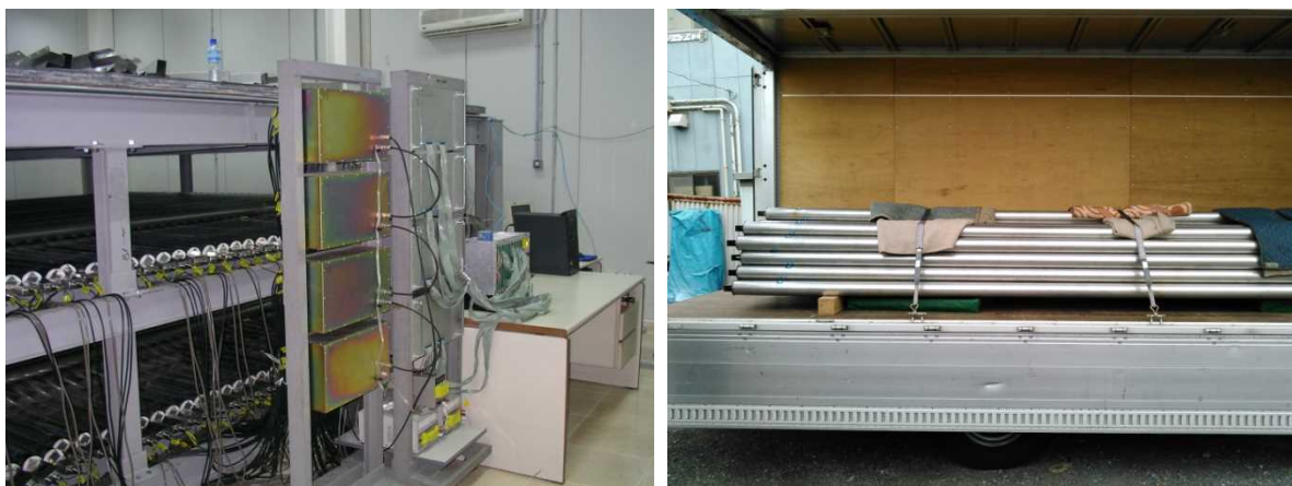
図 1 （左）2006 年 3 月に設置されたクェートのミュオン計、設置時点の検出面積は 9 m 2 であるが将来に 25 m 2 に拡張可能な構造になっている（右）同装置の拡張のために開発された比例計数管 80 本をコンテナに積んだもの
