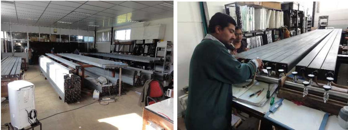
図2 (左) 比例計数管の制作現場と(右) 真空漏れの検査の様子
