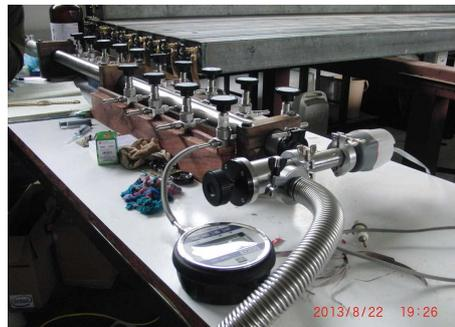
写真左は現地における比例計数管を真空作業の様子。写真右は真空計装置の一部。
