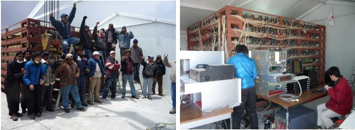
2013年4月に、メキシコ INAOE から移送され、Sierra Negra 山頂で組上げられた SciCRT 検出器 (左)。観測小屋内でマルチアノード光電子増倍管 (MA-PMT) と計測システムが接続され、試験観測を開始した SciCRT (右)。
