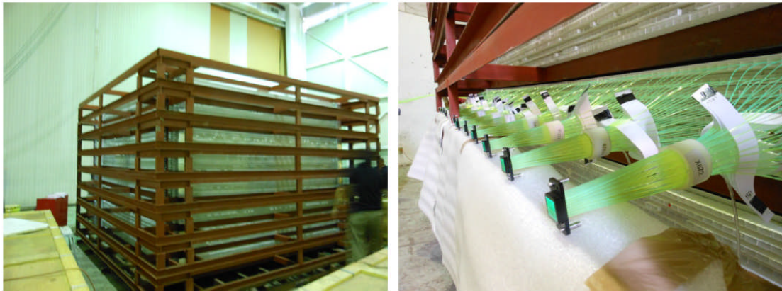
2011年8月にメキシコの施設内で組み上がった検出器（左）と装着された波長変換ファイバー（右）
