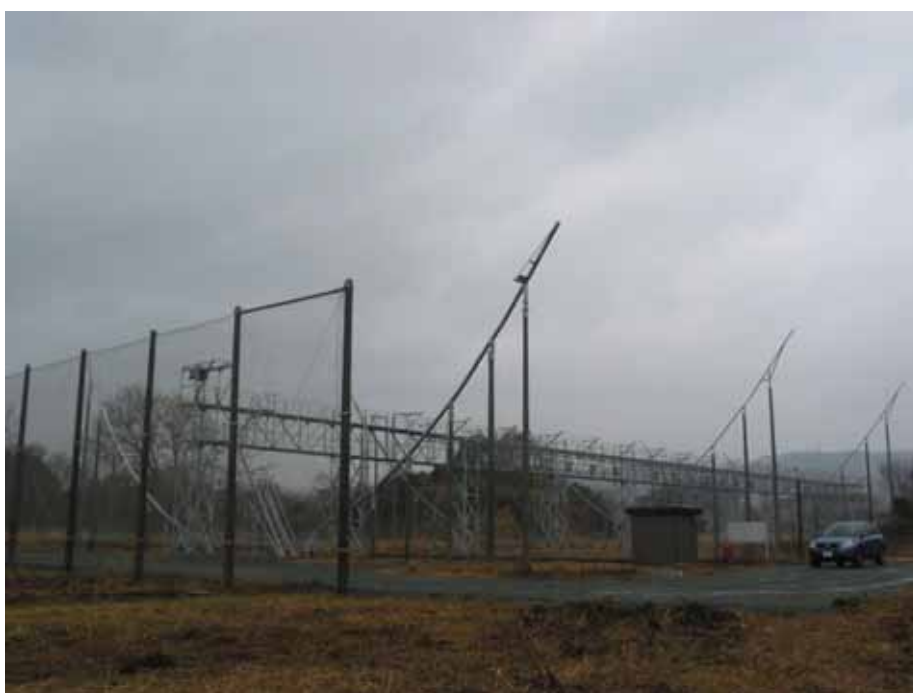
図2 豊川観測所の新IPSアンテナ（太陽圏イメージング装置、SWIFT）
